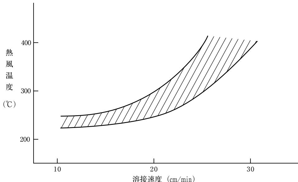
図4-2 溶接速度と熱風温度——ノズル先端1cmの所の温度計の指示温度
