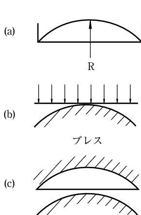
② 図のように曲率Rで曲げ加工する場合は、(a)のようにRを初期に与えて昇温し、歪をなくすという方法は加工上都合は良いですが、①のような問題が残ります。このような場合は、板の軟化に従って型に沿わすか[(b)]、板の温度を上げて型押し[(c)]、または真空成形してください。
