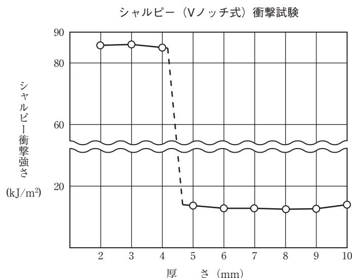
上記から明らかなように、Vノッチ付シャルピー衝撃試験ではポリカーボネートの破壊には延性破壊と脆性破壊があり、その転移厚さは4～5mmの範囲に存在します。
