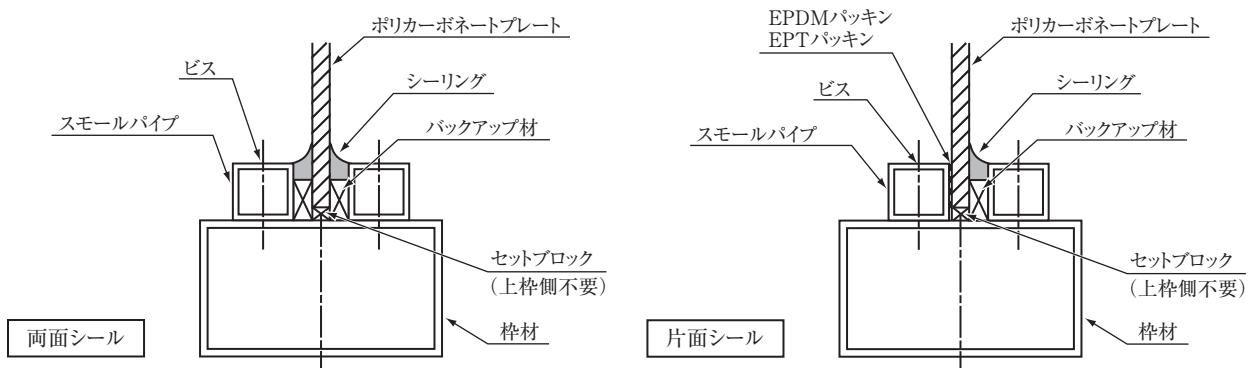
壁面納まりの膨張クリアランスは、必要量を上枠周りで取る設計としてください。
