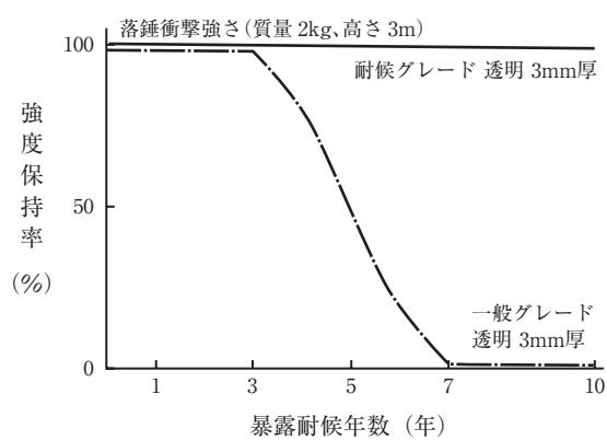
サンシャインウェザオメーターによる耐候性の促進試験結果を以下に示します。
