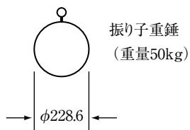
サッシュを試験装置に垂直に固定し鋼球を振り子状につるし、落差300、600、900 mmの高さからポリカーボネートプレート中央部に衝撃を加えた。
