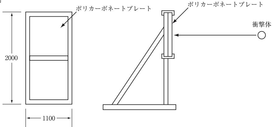
1100 × 2000 mmの鉄枠にシャコ万力でサッシュに嵌め込んだポリカーボネートプレートを取付け、種々の物体を力いっぱい投げつけ、ポリカーボネートプレート、サッシュ、ビードおよびシーラントの状況を調べた。
