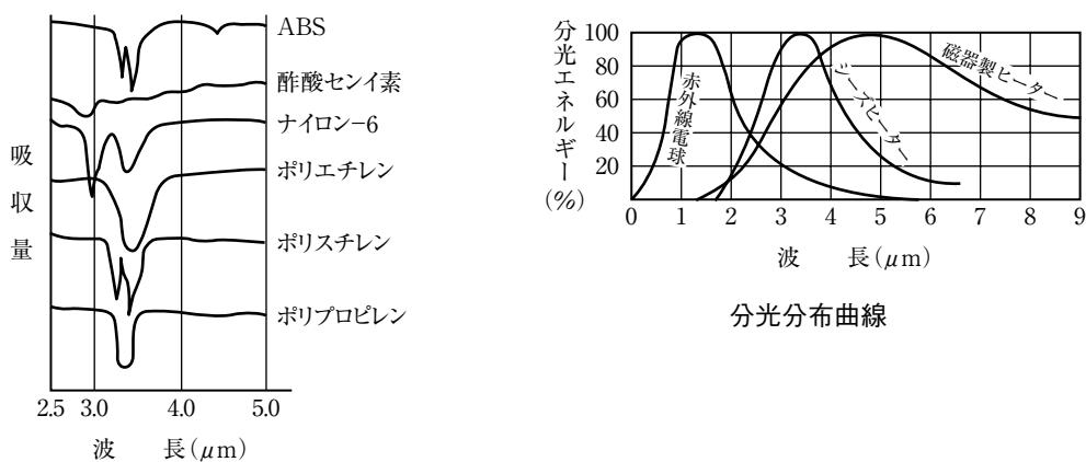
熱可塑性プラスチックの熱線吸収曲線
