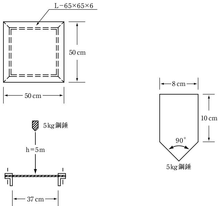
内寸  $370 \times 370$  mm の鉄製枠に試験品をボルト固定し、5 kg の鋼錘を高さ 5m から中央部に自然落下させ、試験品の破損の有無を調べた。
