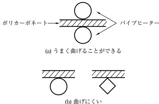
この系統のヒーターは、ヒーターとプレートが線接触するため、熱の移動量が少ないので両面加熱（ヒーターでポリカーボネートをサンドイッチにする）が必要です。パイプヒーター両面加熱をすると、5mm程度の板厚まで曲げることができます。角ヒーターは板との接触が小さいため軟化しにくく好ましくありません。
