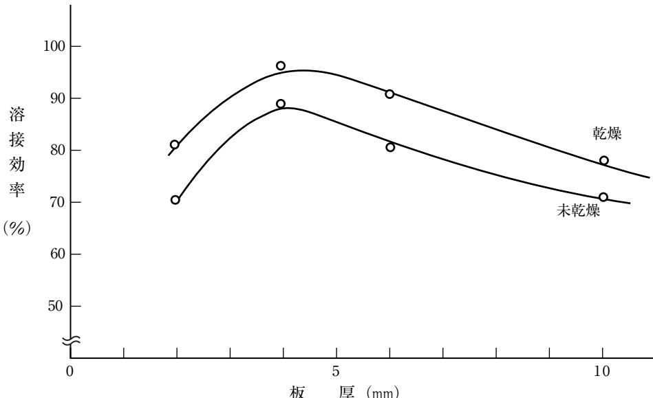
図4-3 板厚と溶接効率 乾燥—400°C 未乾燥—280°C (ノズル先端 1 cm)
