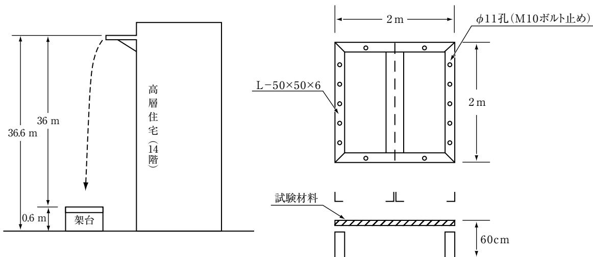
14階ベランダより、種々の物を自由落下させ、地上に設けた架台上の試験材料に衝突させた。
