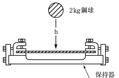
試験片寸法50×150 mmとし150 mmの両端を25 mmずつ保持器で水平に押さえ、ポリカーボネートは5 mの高さから、アクリルは1.2 mの高さから鋼球を垂直に自然落下させ、試験片の破損の有無を調べた。
