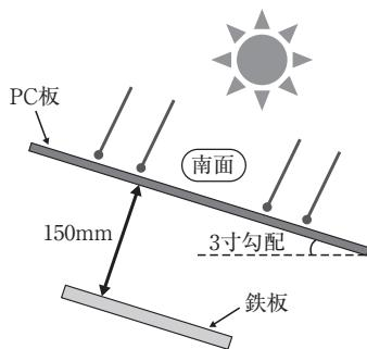
3寸勾配をつけた試験台にPC板(2mm厚)を止めつけ、150mm離れた位置に鉄板を置き、鉄板及びPC板表面の温度変化を観察した。
