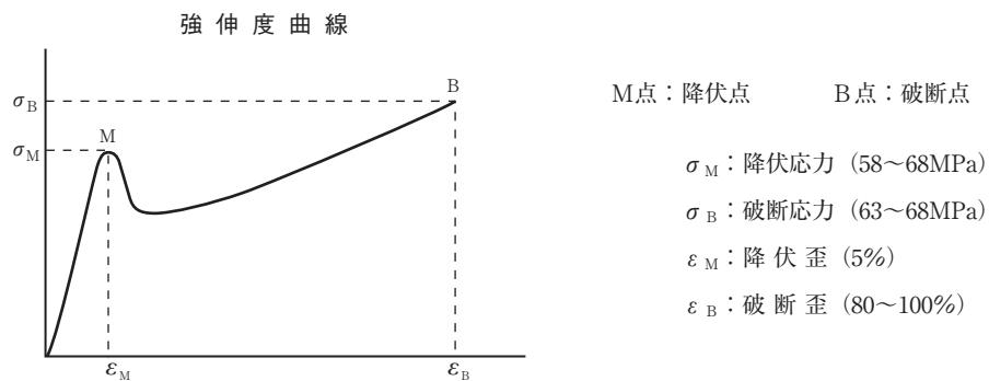
試験片を引張ると、上記のようにまず降伏点 M でいったん応力が下がります。更に引張ると、破断点 B まで徐々に増加します。M 点から B 点までが長いのがポリカーボネートプレートの特長であり、このことから、伸び率（引張破壊時呼びひずみ）の良いことがわかります。
