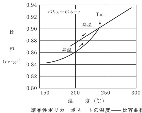
ガラス転移点は一般に分子運動が凍結される温度とされており、これを越えると分子運動が始まって容積、誘電率、屈折率、圧縮率、熱伝導率などの物理特性が急激に変化します。また、溶融温度は分子量、結晶化度などによって異なり、また高分子物質では明瞭に認められ難く、普通ある範囲をもちます。
