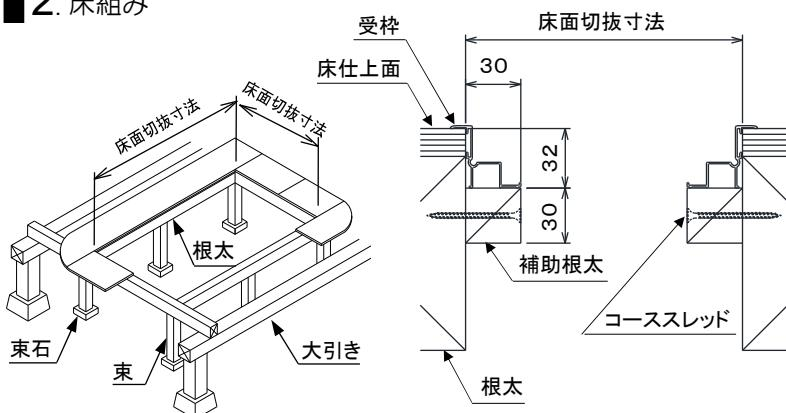
①床面切抜寸法で床下物入れを設置する床面を開口し、根太を全周にまわします。
