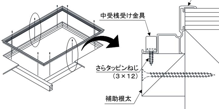
②受枠に取付けた中受棧受け金具に中受棧を載せ、蓋をはめ込みます。
